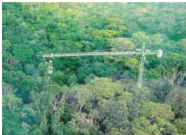
Schlüssel in eine unbekannte Welt - der Turmdrehkran fährt auf 120 m langen Schienen, ist 40 m hoch und hat eine Auslegerlänge von 40 m. Er ist kein Feindbild für die Tierwelt, sondern Teil des Lebensraumes am Surumoni.
